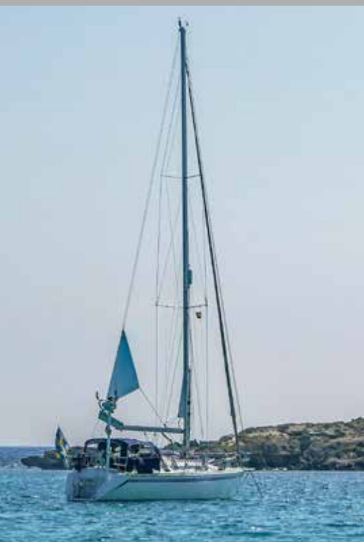
Ankarseglet gör att vi ligger lugnare. Med kort hanfot når vi att haka på det ovanför så att det sitter stabilt. Vi hissar med dirken och skotar med spirbomsnedhallet i mastfoten; båda är dragna till sittbrunnen så att man enkelt kan hissa och bärga själv. Seglet minskar inte bara rycken och lasten på ankaret, det gör också solcellerna effektivare då båten inte svänger så mycket.
