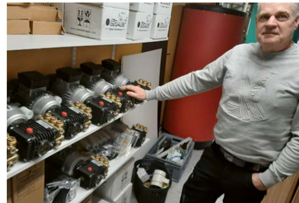
Växelströmsmotorer som drivs av en inverter från litiumbatterier, är Ulf's nya koncept. Då blir kabeldragningen mycket enklare.
