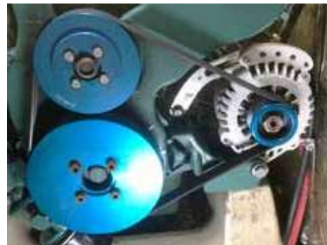
Vi hade precis plats för den större Balmar generatortill och de större flerspårsremskivorna
